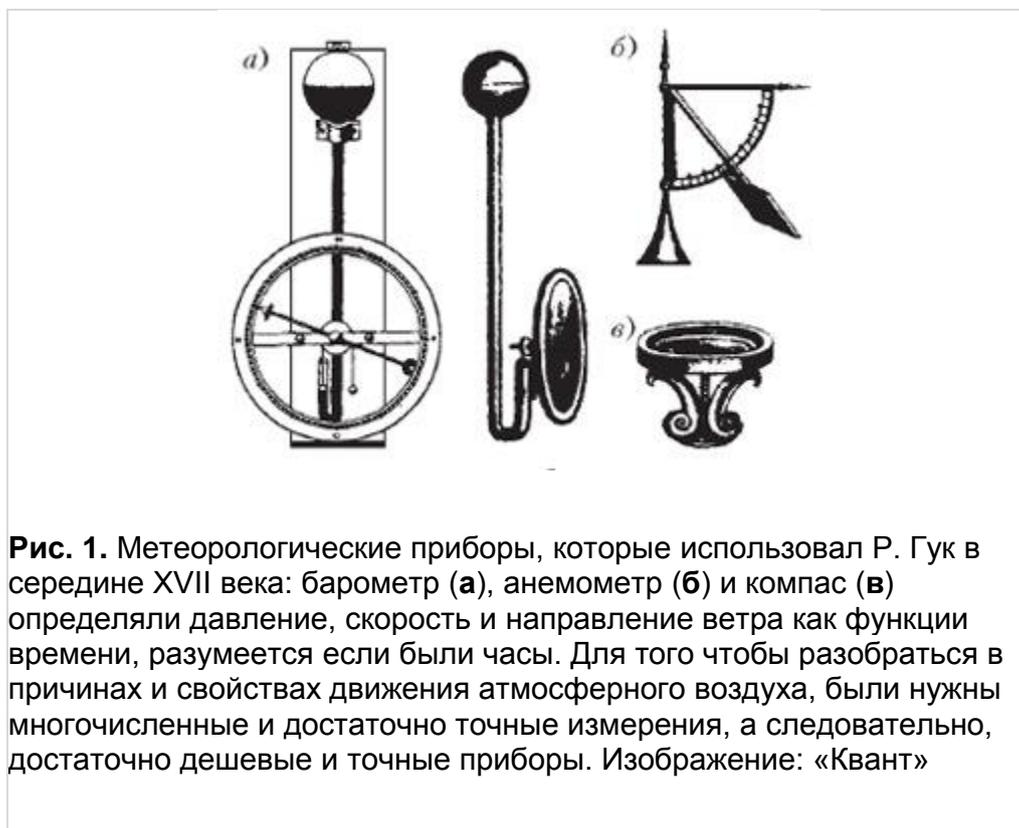
**Рис. 1.** Метеорологические приборы, которые использовал Р. Гук в середине XVII века: барометр (а), анемометр (б) и компас (в) определяли давление, скорость и направление ветра как функции времени, разумеется если были часы. Для того чтобы разобраться в причинах и свойствах движения атмосферного воздуха, были нужны многочисленные и достаточно точные измерения, а следовательно, достаточно дешевые и точные приборы. Изображение: «Квант»
