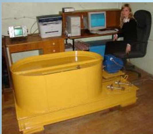
Установка компараторная для проверки вертушек
