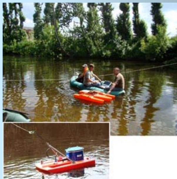
Испытания новых средств измерения расходов воды: акустических профилографов Stream Pro и Rio Grande 1200 кгц. (вверху) акустический профилограф Stream Pro.
