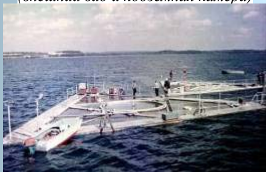
Плавучая водноиспарительная установка на озере Валдайском
