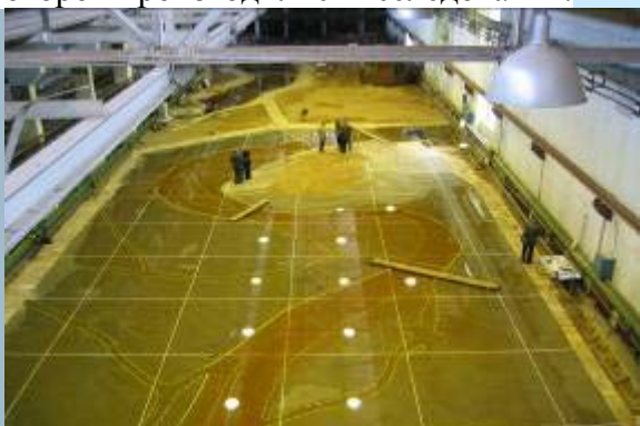
Лабораторные исследования руслорегулирующих мероприятий на пространственной модели р. Иртыша у г. Ханты-Мансийска.
