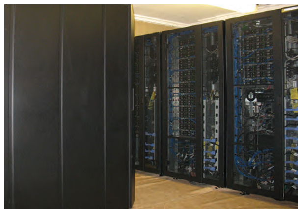
Установлен сервер IBM z9BC и дисковый массив IBM DS8300
