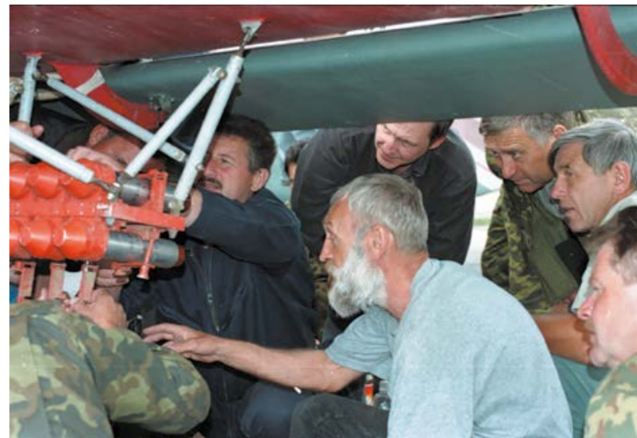
Снаряжение самолета Ан-2 генераторами САГ-П на устройстве КУСАГ-П
