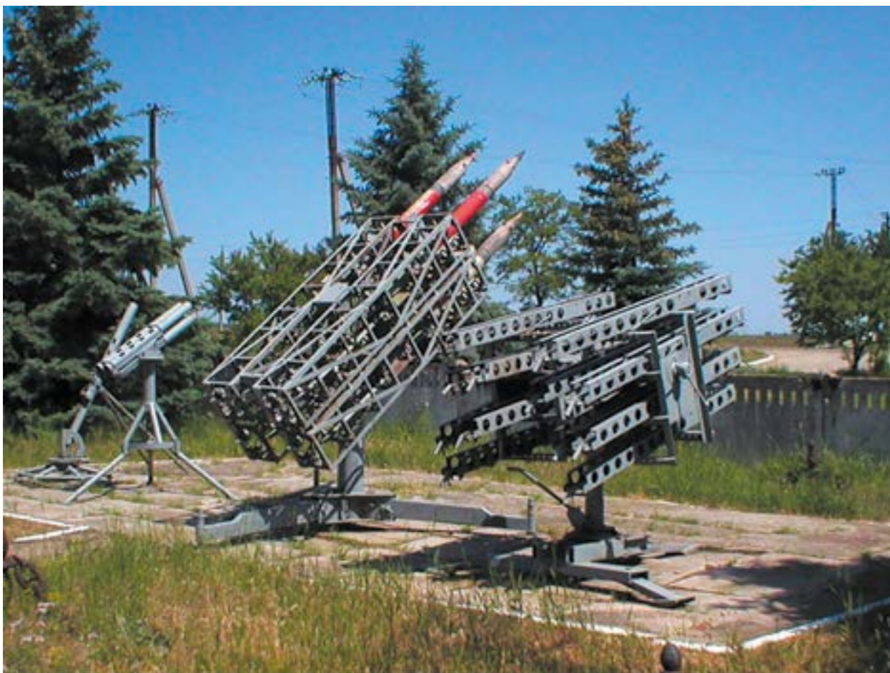
Образцы пусковых установок в Джанкойском отряде для ракет ПГИ, «Облако» и «Алазань–Кристалл» (слева направо)
