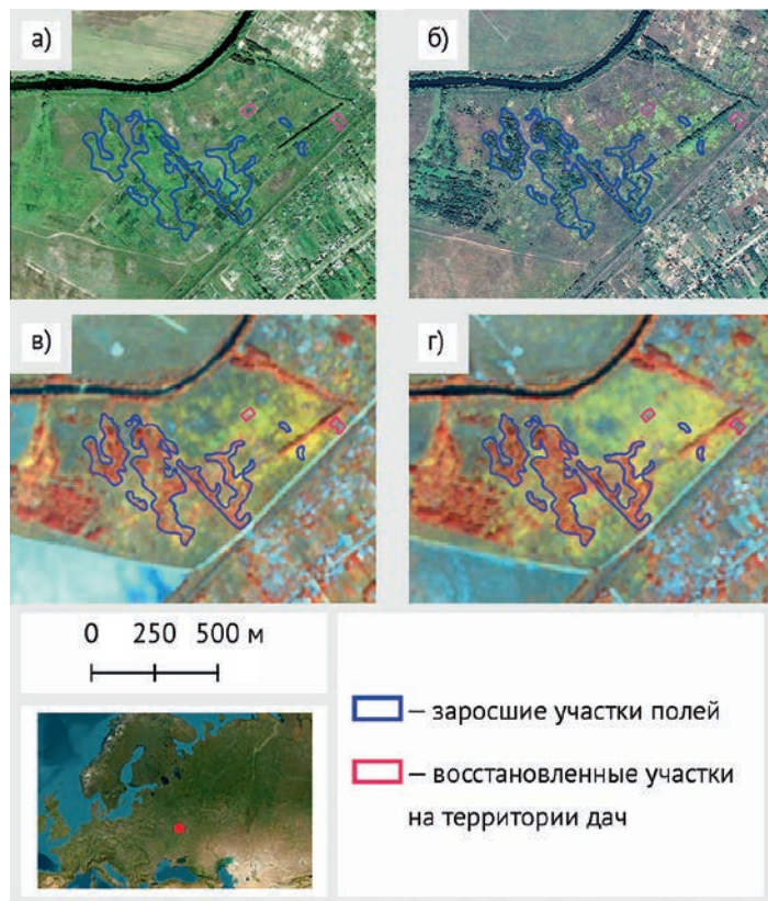
Рис. 22 [15]. Участки заброшенных дач. Сопоставление на снимках разной детальности и времени съемки: сверхвысокодетальные 2002 года (а) и 2014 года (б) (Google earth pro, комбинация каналов «естественные цвета»); высокодетальные 2015 года (в) и 2021 года (г) (Sentinel-2, комбинация каналов «искусственные цвета»). Интересно отметить, что к 2021 году в, казалось бы, окончательно заброшенной деревне начали разрабатывать участки
